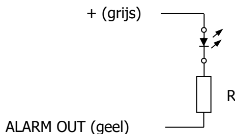
Een LED verbinden met Alarm OUT (kabel 3)
